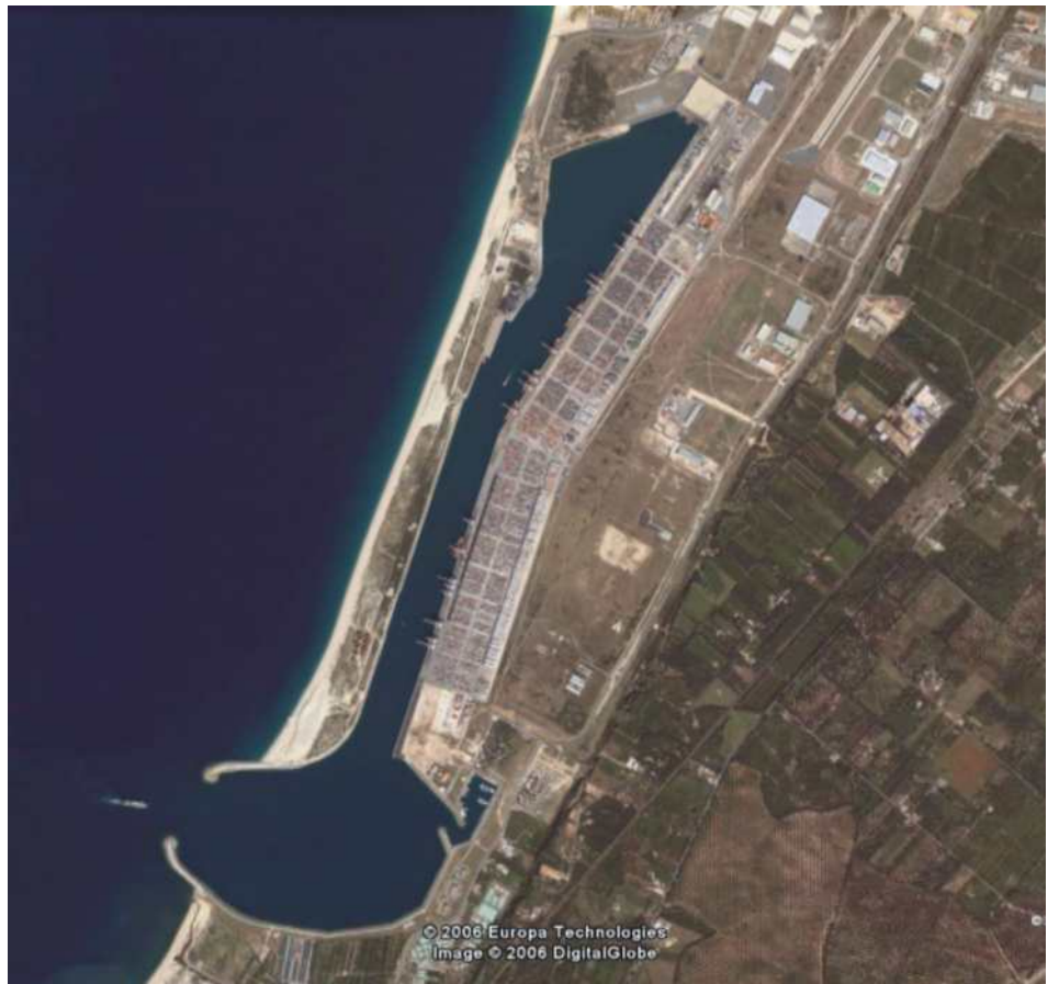
Figura 7.0.12: Porto di Gioia Tauro. Dove non esistono le condizioni naturali, il porto canale può essere completamente artificiale come accade a Gioia Tauro (RC) dove il porto è stato realizzato nel retrospiaggia con andamento parallelo alla costa. Foto Google Earth.
