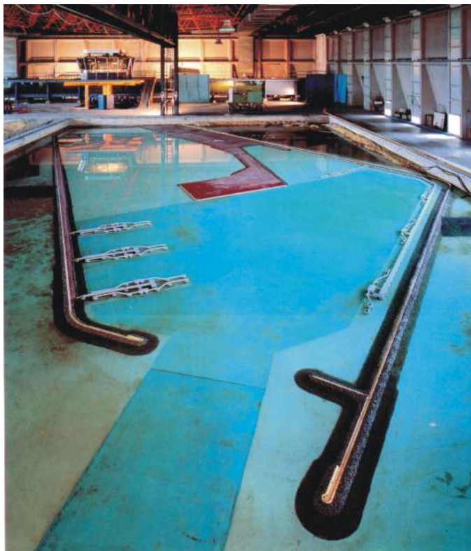
Figura 3.3.2: Modello fisico tridimensionale a fondo fisso, da ESTRAMED s.p.a., 1990.
