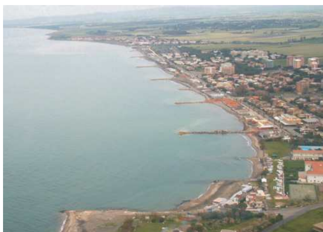
Figura 3.4.10: Ripascimento protetto a Tarquinia, Aprile 2004 ed Agosto 2004. Sono stati utilizzati una serie di pennelli trasversali per ridurre la perdita e quindi la frequenza dei ricarichi di sabbia mediante ripascimento (Osservatorio Regionale dei Litorali, Regione Lazio, 2004).
