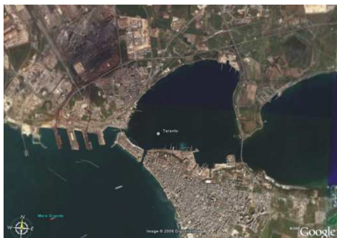
Figura 7.0.5: Taranto, porto del mar Piccolo. Esempio di porto protetto con un unico canale di accesso ed un ampio bacino portuale al proprio interno.
