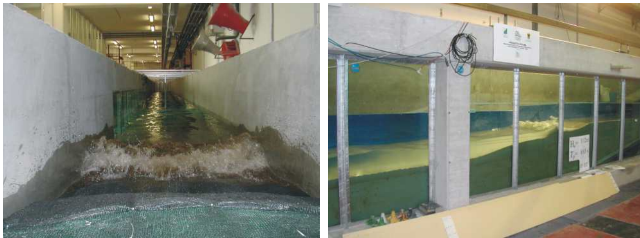
Figura 3.3.1: Modello fisico bidimensionale in canale, dal Laboratorio di Ingegneria Ambientale e Marittima dell'Università de L'Aquila.
