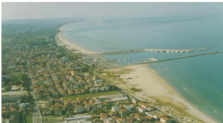
Figura 2.0.2: Porto di Giulianova (TE): Interferenza dell'opera marittima con il regime di trasporto dei sedimenti. Qualunque opera marittima introduce una modifica della naturale dinamica litoranea e interferisce con il regime di trasporto dei sedimenti. Un'opera di protezione limitata ad un breve tratto di costa in erosione può innescare nuovi fenomeni erosivi nel tratto di costa non protetto a valle della direzione prevalente del trasporto solido litoraneo. Una conoscenza non adeguata dei fenomeni di dinamica costiera può dar luogo a interventi che si rivelano successivamente più dannosi che efficaci.
