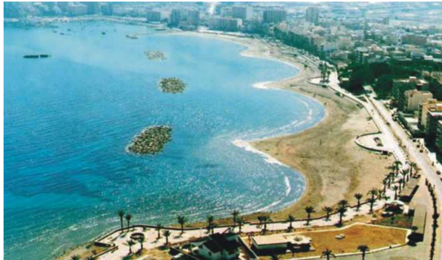
Figura 4.4.19: Andamento a cuspidi della linea di riva influenzato dalla presenza di opere di protezione. (Foto Beachmed).
