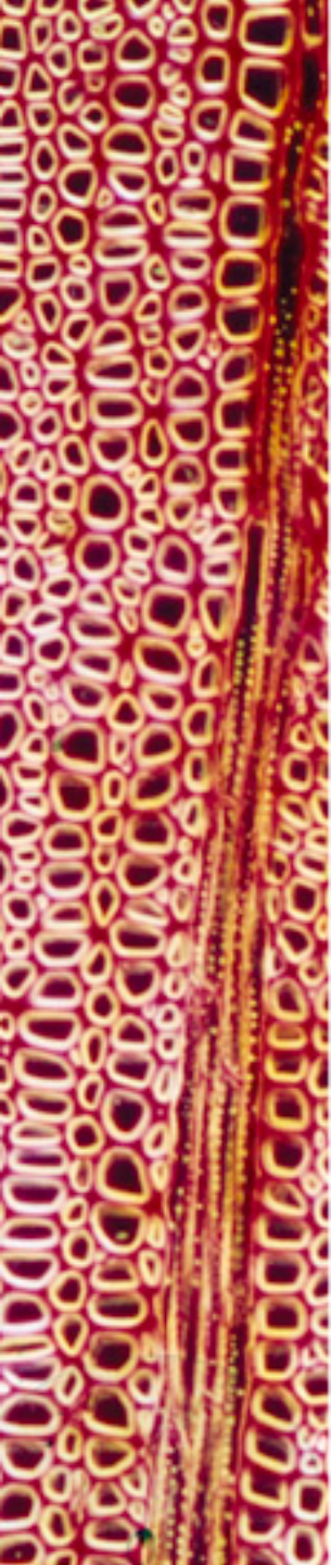
Punteggiature areolate in fibrotracheidi di una conifera viste in sezione al microscopio ottico.
