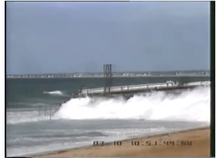
Gaz de France - Lorient LNG RPT tests (1981)
