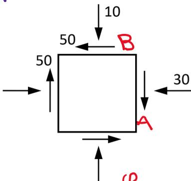
**Quesito n. 2 [6/13].** In figura è rappresentato in forma grafica lo stato tensionale (biassiale) in un punto di un solido (tensioni in N/mm<sup>2</sup>). Costruire la circonferenza di Mohr e determinare le due tensioni principali relative al piano rappresentato in figura. Determinare in seguito, sempre graficamente, intensità e verso di rotazione (orario/antiorario) dell'angolo con il quale ruotare il rettangolo affinché esso si allinei alle direzioni principali di tensione.
