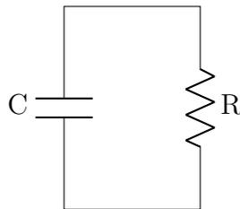
Figura 2: Semplice circuito RC con sola scarica
