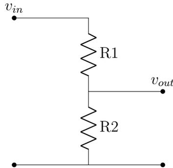
Figura 1: Partitore di tensione
