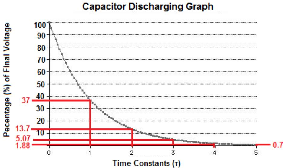
Figura 3: Scarica condensatore
