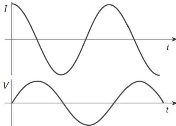
Figura 7: Sfasamento tra tensione ai capi di un condensatore e corrente prodotta dalla capacita' per reazione. Si noti lo sfasamento di  $90^\circ$ .
