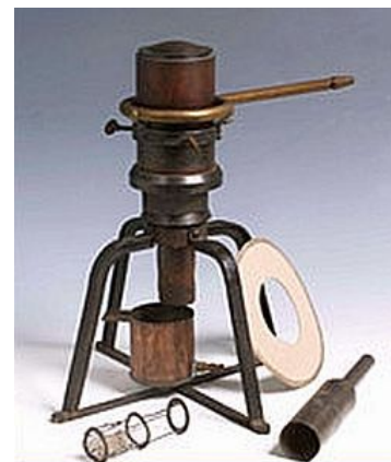
L'apparato originale usato da Giorgio Spezia per la crescita di cristalli di Quarzo.
