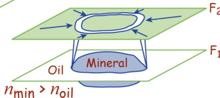
Abbassando il piatto del microscopio il fuoco va da  $F_1$  a  $F_2$  e la linea di Becke si sposta verso l'esterno del minerale se  $n_{min} < n_{oil}$ , e verso l'interno del minerale se  $n_{min} > n_{oil}$
