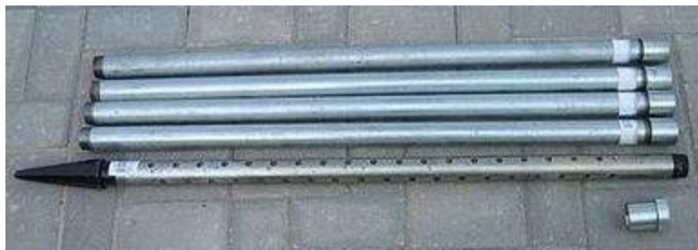
Figura 32 Tubazioni, puntazza e tubo finestrato per la realizzazione di un pozzo a percussione.
