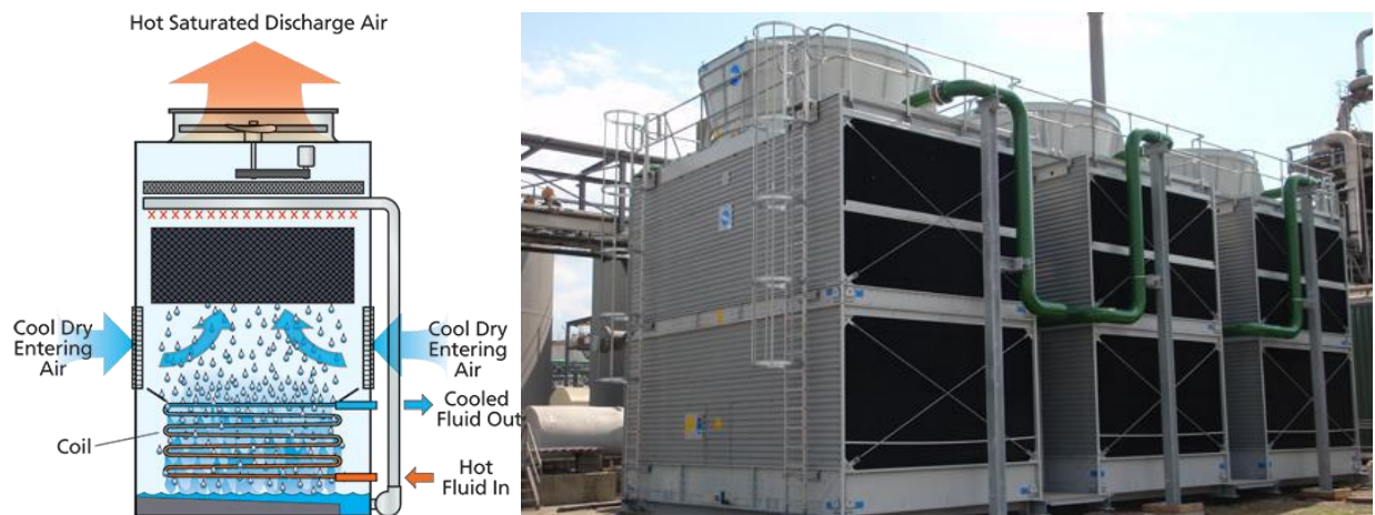
Figura 93 Batteria di scambio termico alettata
