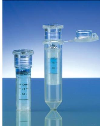
Il processo della ultrafiltrazione si basa sempre sulla **permeabilità selettiva** delle molecole attraverso una membrana, quindi è concettualmente molto simile alla DIALISI, ma in questo caso si utilizza la **forza centrifuga** per forzare le proteine attraverso la membrana stessa. Anche in questo caso le membrane da ultrafiltrazione sono caratterizzate da un valore di **cut-off**.
