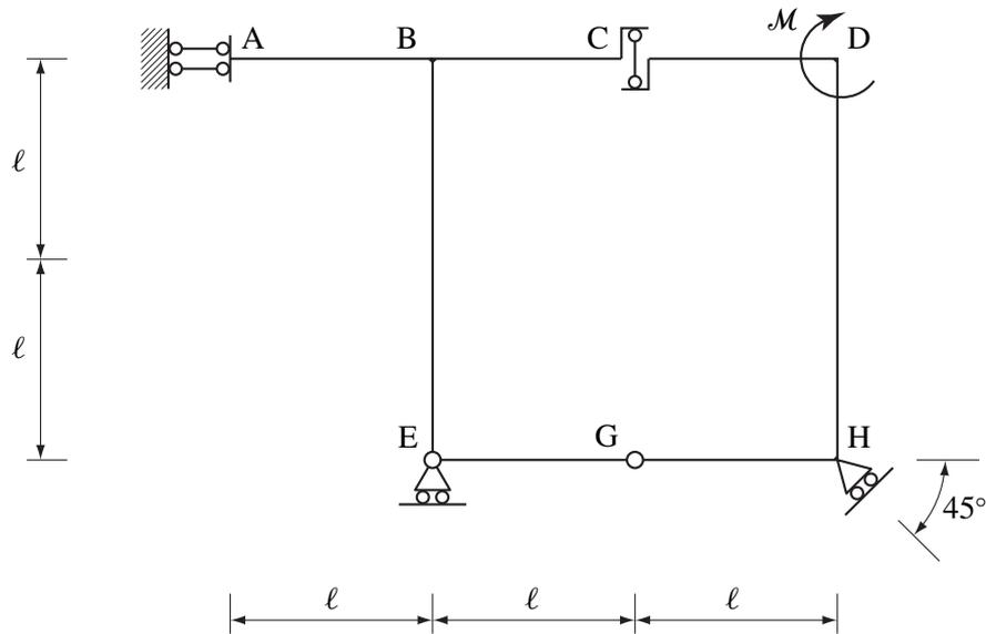
Data la struttura isostatica di figura, soggetta ad una coppia agente in corrispondenza del nodo D:
