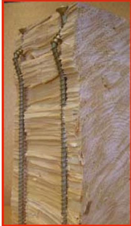
ROTTURA PER INSTABILITA' (BUCKLING)
