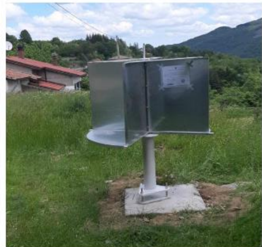
Figura 13 – Riflettore artificiale installato. Fonte: archivio UniFI
