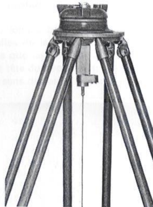
Fig. 5 Mise en place de la nivelle sphérique et du fil à plomb
