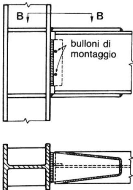
**Giunto con fazzoletto superiore saldato e anima bullonata** (simile ad A ma più delicato). Nella piastra coprigiunto si formano presto delle fessure per cui la duttilità è minore rispetto a giunti saldati e giunti di tipo A.
