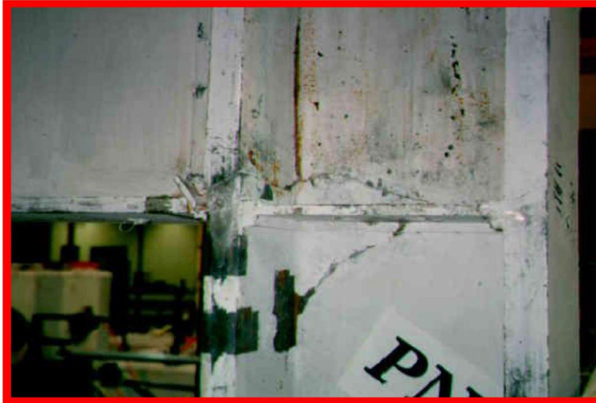
Collegamento interamente saldato
