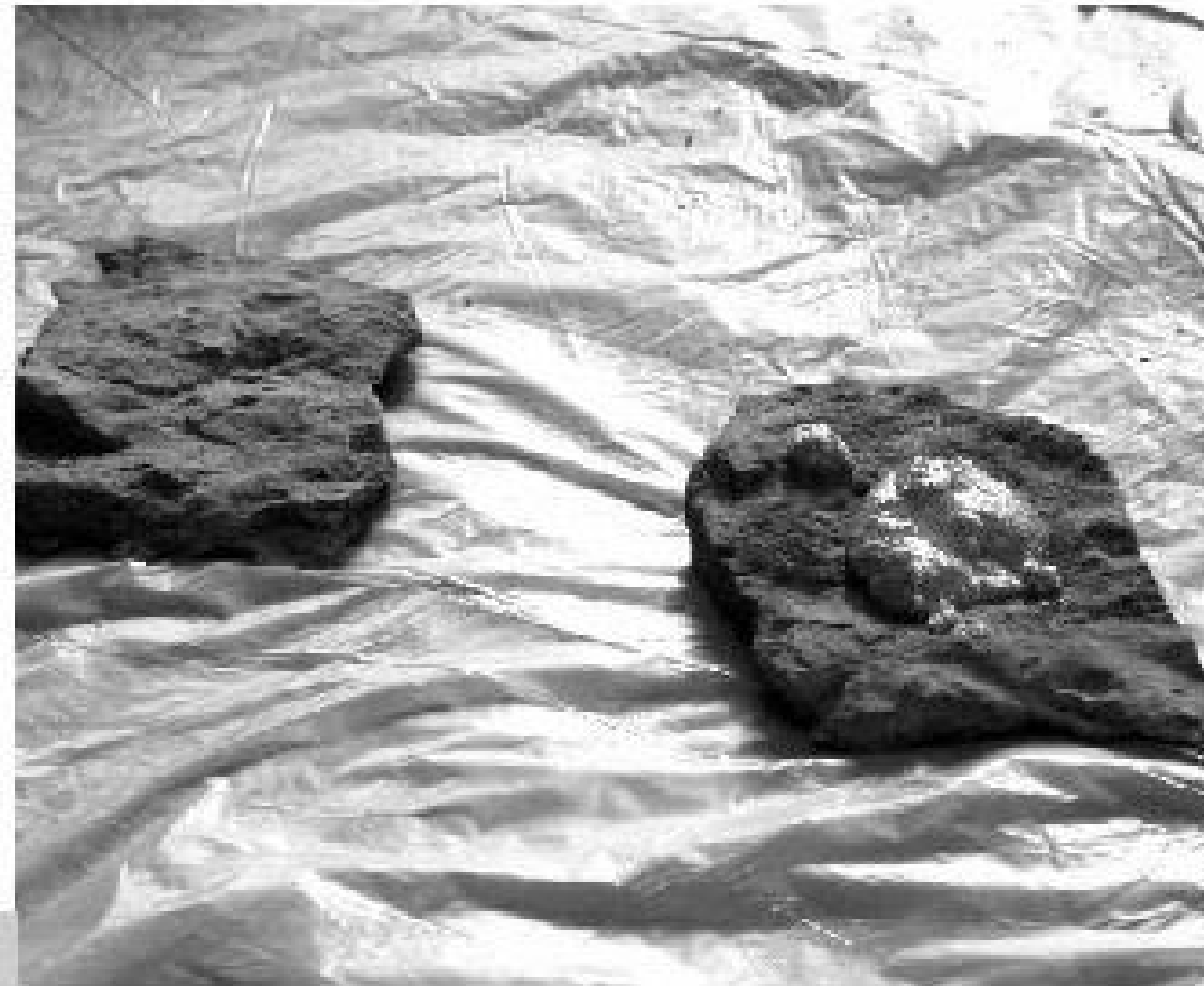
Figura 1 • Operazione di riadesione mediante incollaggio. Consiste nel ricollegare tra loro, o con il manufatto di cui sono parte, frammenti di pietra parzialmente o totalmente distaccati mediante l'applicazione di collanti.
