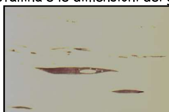
Stringler longitudinali di inclusioni (esame macroscopico).
