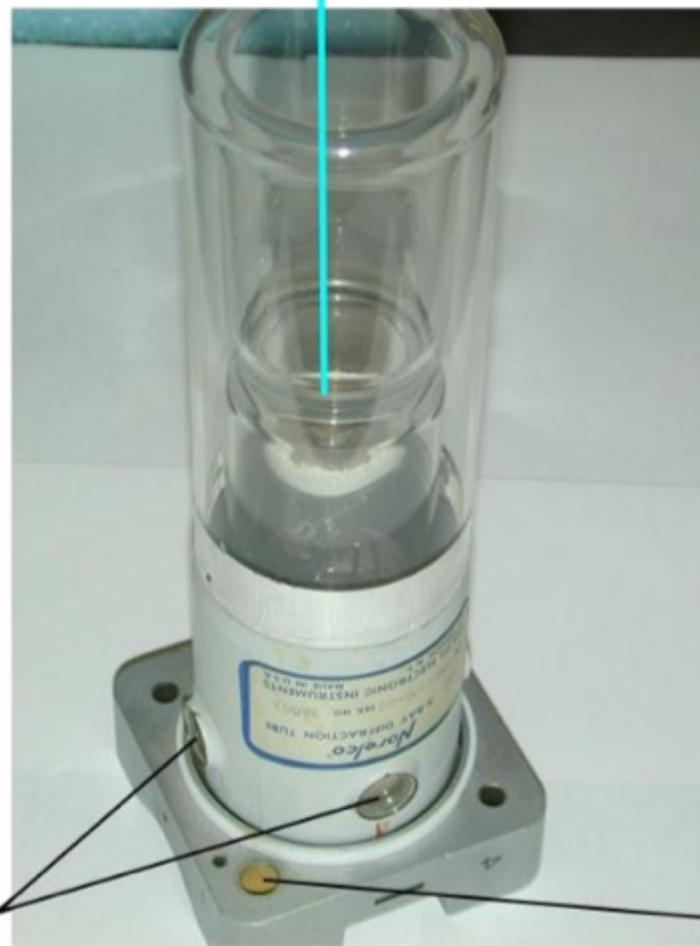
La maggior parte dell'energia degli Elettroni viene dissipata in calore (il rendimento in radiazione è inferiore all'1%) che viene sottratto all'anticatodo mediante un circuito di raffreddamento ad acqua.
