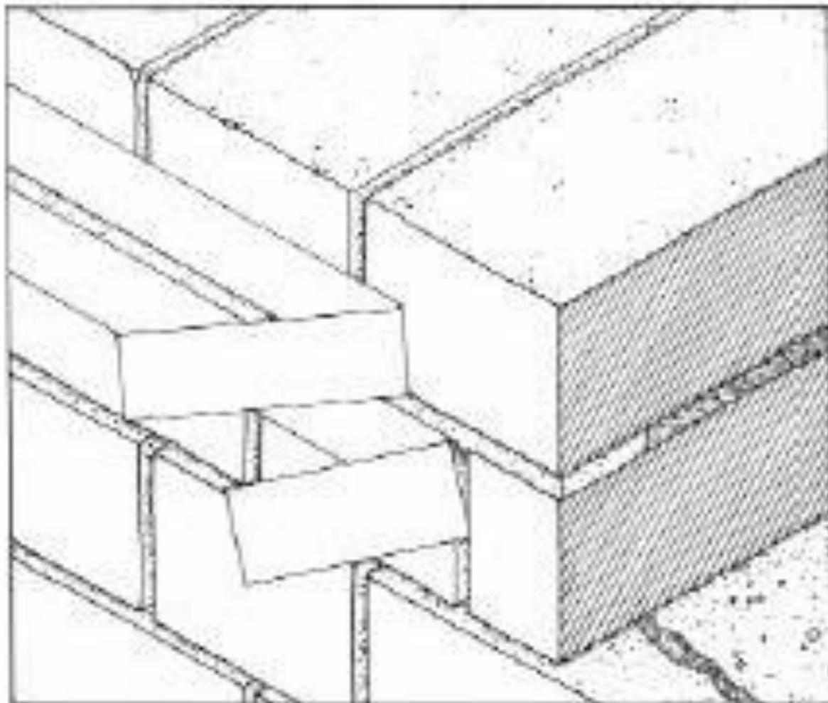
Figura 5 • Rimozione della protezione dei bordi.
