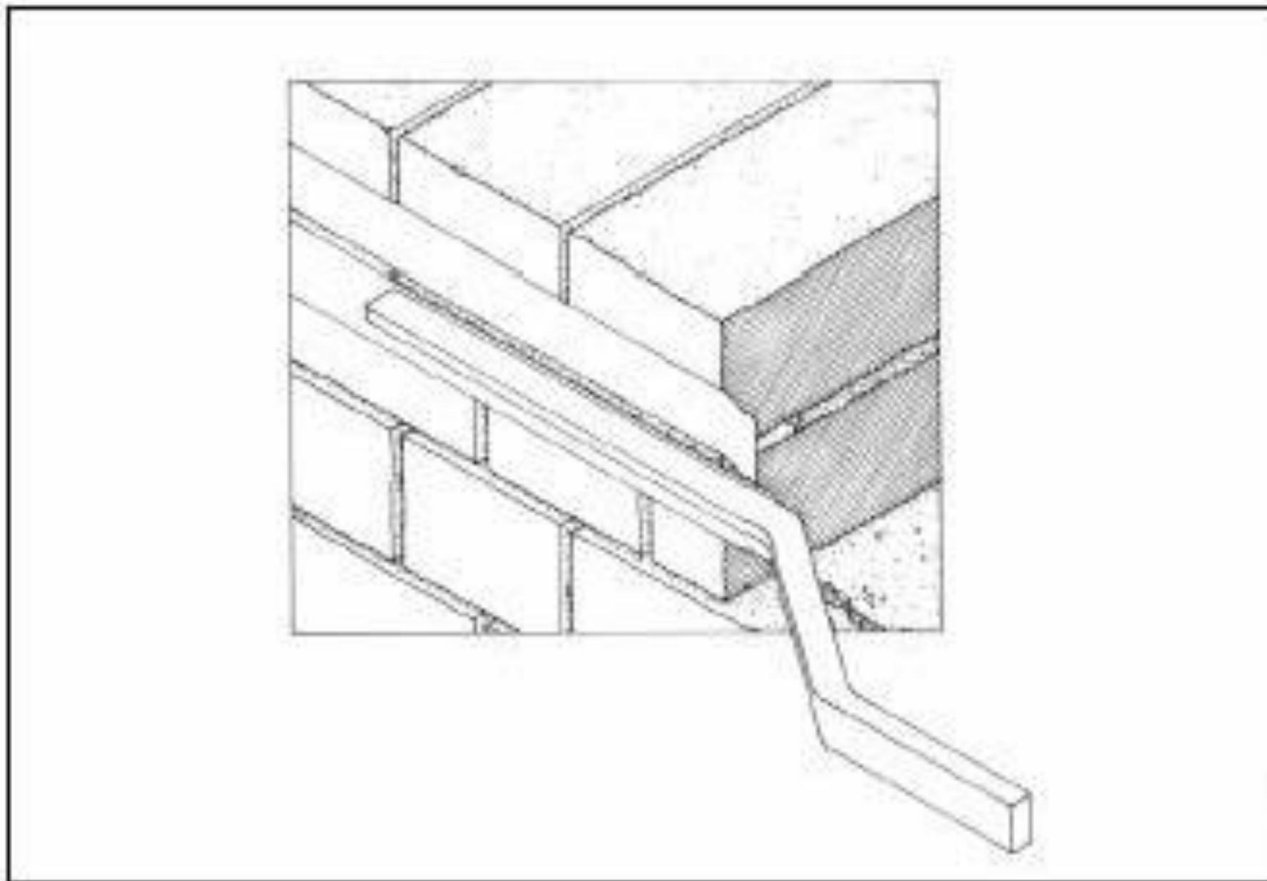
Figura 4 • Stilatura del giunto con un ferro adatto.
