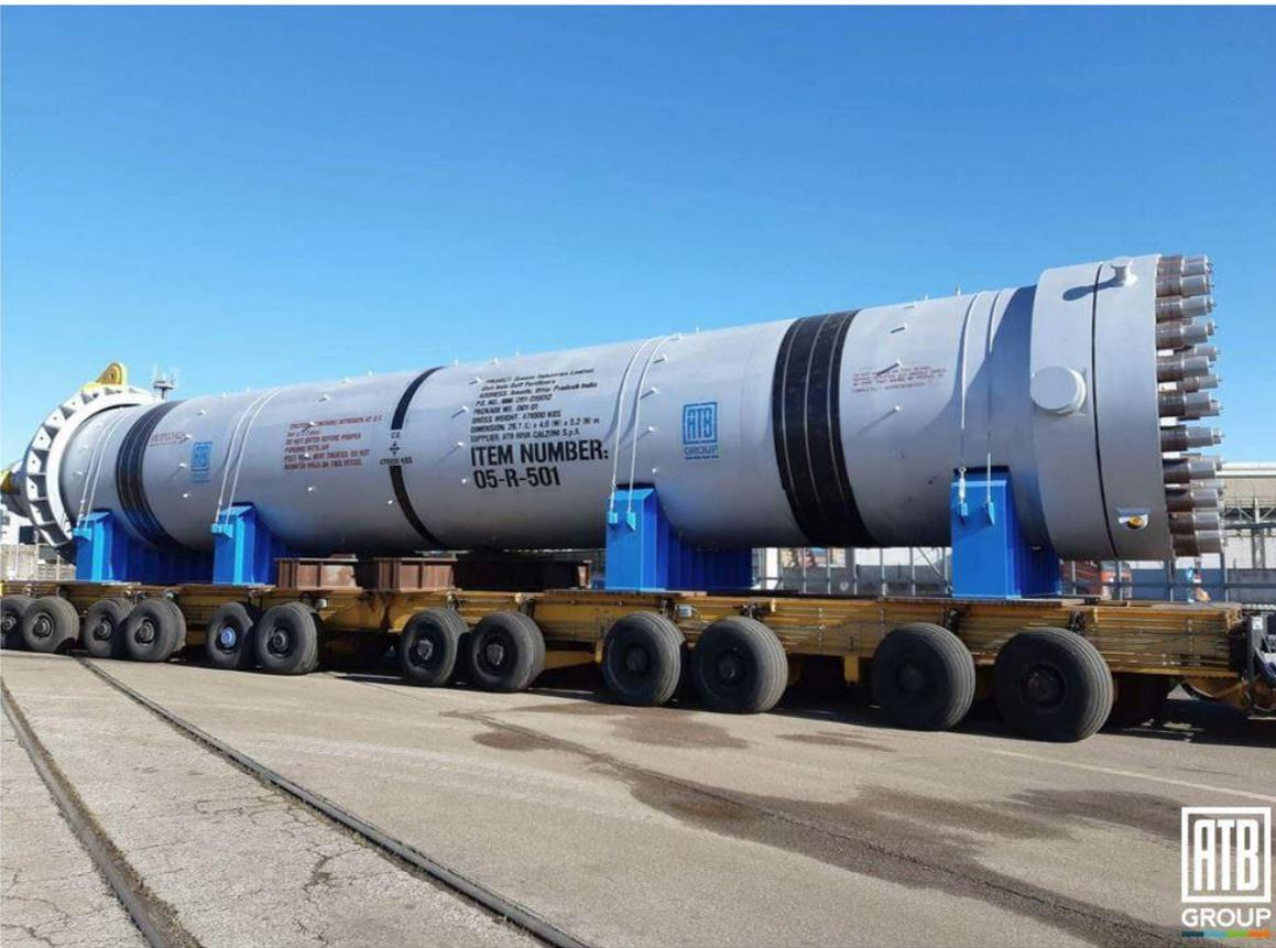
Moderno *converter* per produrre ammoniaca, **3m di diametro, 21.5 m di altezza, ca. 460 tonnellate**, parete singola (spessore di **190 mm**) di acciaio al cromo-molibdeno
