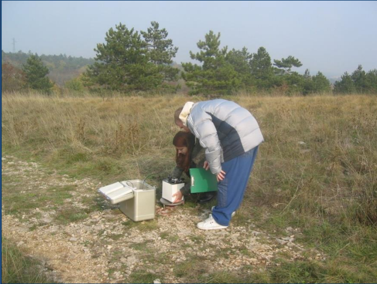
Rilievi gravimetrici Gravimetro Lacoste & Romberg
