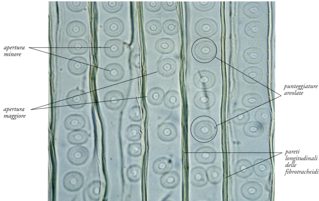
Fibrotracheidi con punteggiature areolate nel fusto di abete bianco ( Abies alba Mill. fam. Pinaceae). Sezione longitudinale radiale. x 400 (480)
