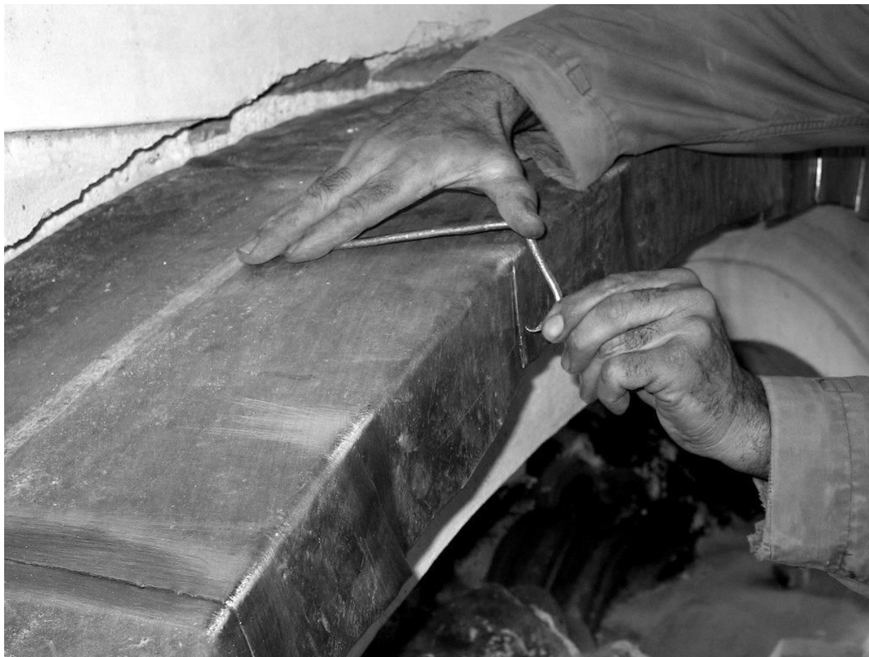
Figura 11 • Incisione della traccia necessaria all'esecuzione del taglio del materiale in eccesso.
