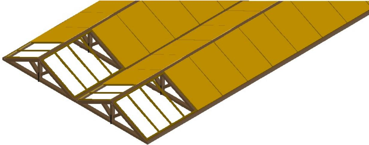
Applicazione di uno o più **pannelli affiancati a base legno** (o CLT) al di sopra dell'orditura principale della copertura, solidarizzati ad essa con **connettori metallici diffusi** (es. chiodi o viti).
