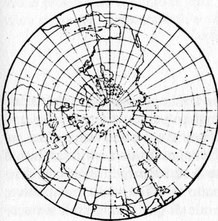
Fig. 35 — Emisfero in proiezione azimutale equidistante polare.
