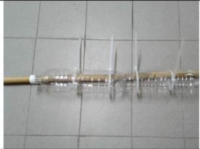
Fig. 17: realizzazione di un galleggiante utilizzando due bottiglie da campionamento e un pezzo di bambù
