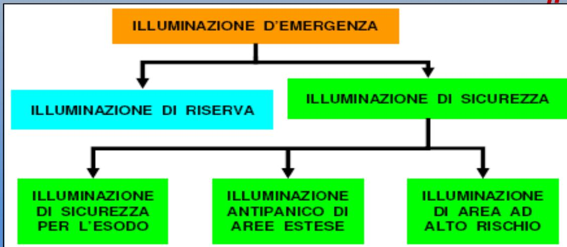
di sicurezza deve fornire, in caso di mancata fornitura principale della energia elettrica e quindi di luce artificiale, un'illuminazione sufficiente a permettere di evacuare in sicurezza i locali (intensità minima di illuminazione 5 lux).
