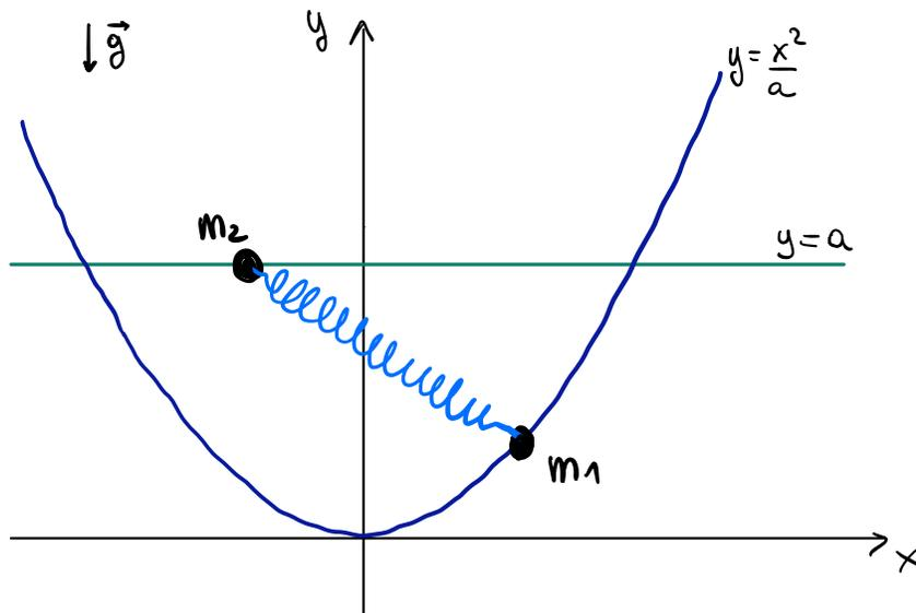
6. Si vincoli il punto di massa  $m_2$  a stare fisso in  $(x, y) = (0, a)$ . Calcolare la frequenza delle piccole oscillazioni del sistema a un grado di libertà attorno ad  $s = 0$  [1pt].
