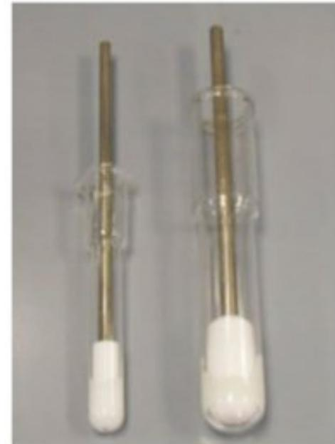
**2) Sonicazione.** Gli ultrasuoni ad alta frequenza sono usati per rompere cellule batteriche e di lievito. Nella sospensione cellulare viene immersa la sonda metallica di un sonicatore che emette onde sonore ad altissima frequenza. Le cellule vengono rotte dalle elevate pressioni locali indotte da queste onde. Svantaggio: surriscaldamento della sospensione cellulare. Per questo i contenitori delle sospensioni cellulari sono immersi in ghiaccio.
