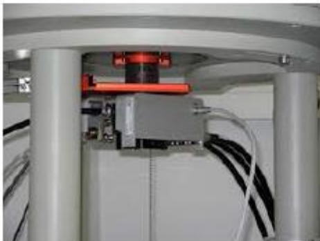
Inserimento del Probe NMR nella parte inferiore del magnete
