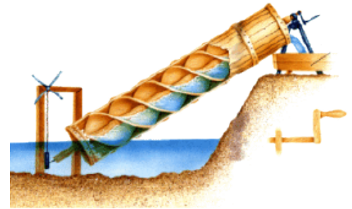
Vite di Archimede o coclea per il sollevamento dell'acqua, primo esempio di pompa volumetrica, III secolo a.C..
