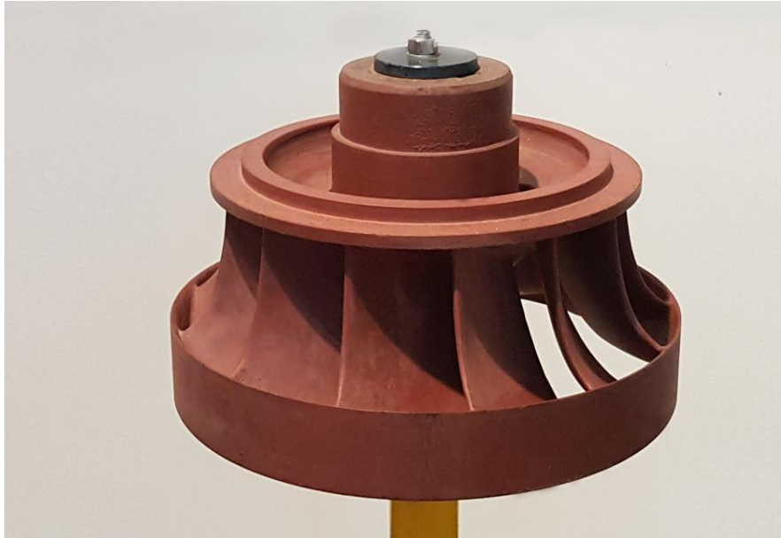
Girante di turbina Francis (macchina idraulica motrice dinamica flusso radiale).
