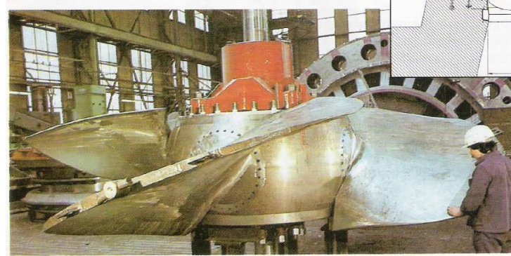
Sezione principale di una turbina a flusso assiale (Kaplan) con caduta utile di 6m, velocità di rotazione 1,3 giri/s, Potenza 6.88 MW e fotografia della girante in officina (Voith).
