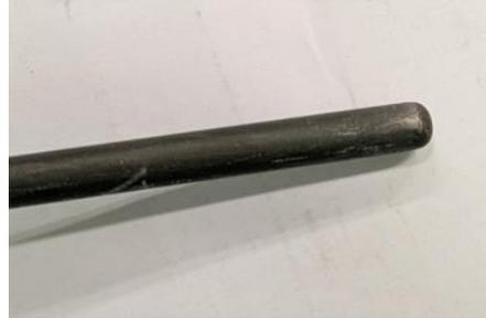
$T_I$ : termocoppia isolata, tipo K
