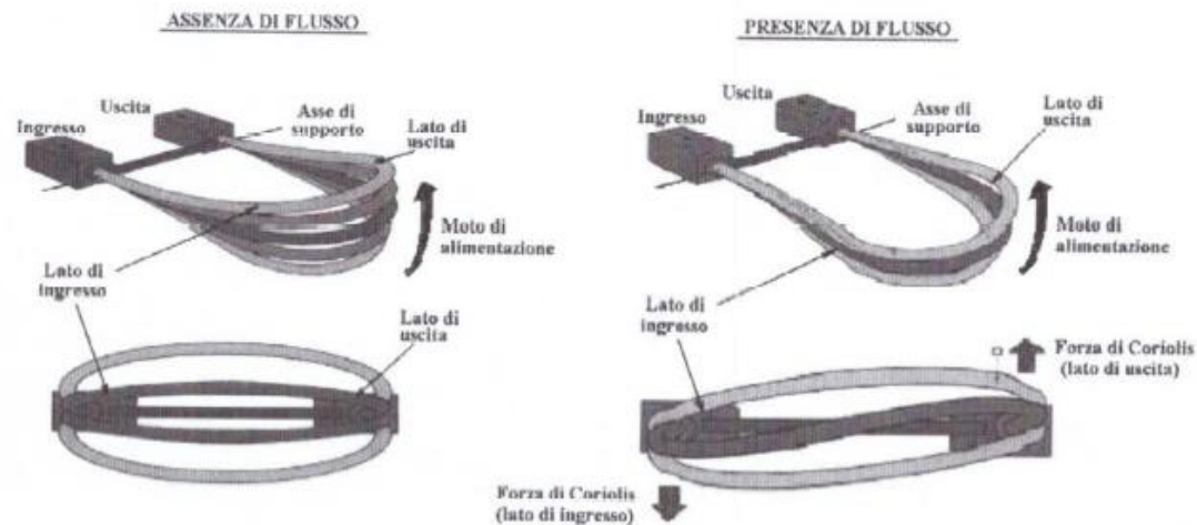
Figura 2.32 – Deformazioni indotte nella tubazione di misura
