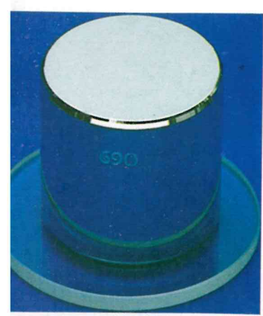
Figura 1.3 Il campione internazionale di massa: un cilindro di 3,9 cm.
