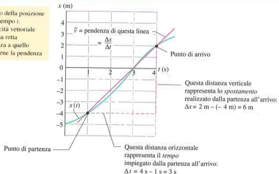
**Figura 2.4** Calcolo della velocità vettoriale media fra  $t = 1$  s e  $t = 4$  s come pendenza della retta che congiunge i punti (sulla curva) che rappresentano i due istanti.
