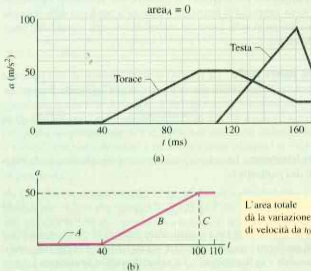
Figura 2.15 Problema svolto 2.6. (a) Curva per il torace e per la testa di un manichino sottoposto a una simulazione d'impatto in un veicolo tamponato. (b) Suddivisione in tre zone del tratto di curva relativo al torace, per facilitare il calcolo dell'area sottesa col metodo grafico.
