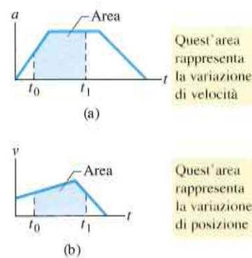
Figura 2.14 Aree sottese tra gli estremi  $t_0$  e  $t_1$  dalle curve che rappresentano (a) il grafico dell'accelerazione  $a$  rispetto al tempo  $t$  e (b) il grafico della velocità  $v$  rispetto al tempo  $t$ .
