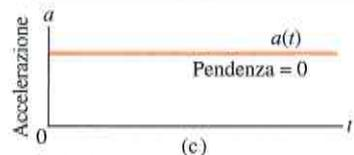
**Figura 2.9** (a) Posizione  $x(t)$  di una particella che si muove con accelerazione costante. (b) La sua velocità  $v(t)$ , data in ciascun punto dalla pendenza della curva in (a). (c) La sua accelerazione (costante), uguale alla pendenza (costante) di  $v(t)$ .
