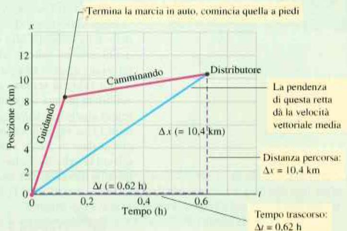
**Figura 2.5** Problema svolto 2.1. Le linee marcate «Guidando» e «Camminando» sono le curve posizione/tempo per il guidatore-camminatore del problema. Le velocità sono assunte costanti. La pendenza della retta che collega l'origine con il punto marcato «Distributore» rappresenta la velocità vettoriale media per tutto il percorso.
