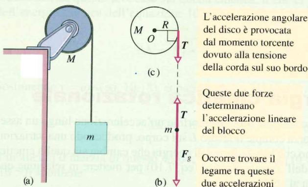
**Figura 10.17** Problemi svolti 10.8 e 10.9. (a) Il blocco, cadendo, fa girare il disco. (b) Il diagramma delle forze relativo al blocco. (c) Un parziale diagramma delle forze relativo al disco.
