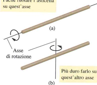
**Figura 10.10** Una lunga asta è molto più facile da ruotare (a) attorno al suo asse longitudinale che (b) attorno a un asse normale passante per il centro, perché la massa nel caso (a) è distribuita più vicina all'asse di rotazione che nel caso (b).
