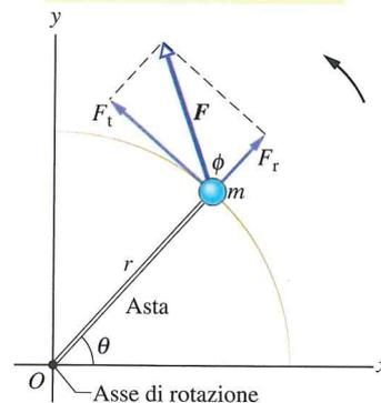
**Figura 10.15** Un corpo rigido semplice, libero di ruotare intorno a un asse passante per  $O$ , consiste di una particella di massa  $m$  fissata all'estremità di un'asticella di lunghezza  $r$  e massa trascurabile. Il corpo ruota per effetto di una forza  $F$  a esso applicata.
