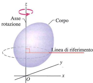
una linea di riferimento è solidale al corpo e normale all'asse di rotazione. Si serve per misurare la posizione del corpo rotante rispetto a una direzione fissa
