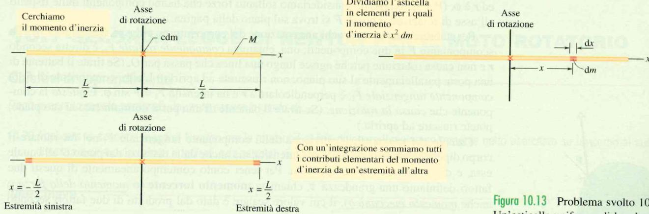
**Figura 10.13** Problema svolto 10.6. Un'asticella uniforme di lunghezza  $L$  e massa  $M$ . È rappresentato un elemento  $dm$  di lunghezza  $dx$ .
