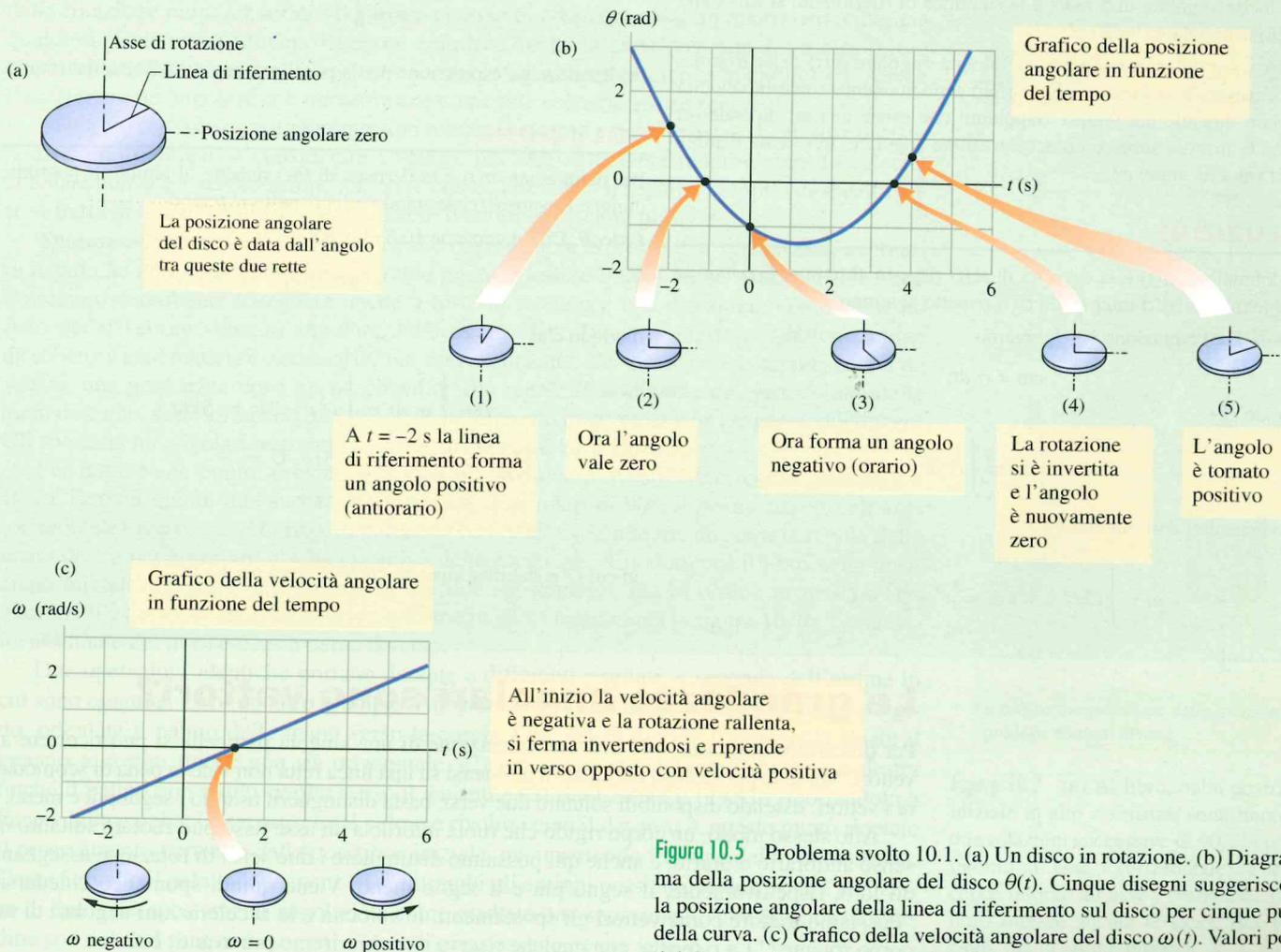
**Figura 10.5** Problema svolto 10.1. (a) Un disco in rotazione. (b) Diagramma della posizione angolare del disco  $\theta(t)$ . Cinque disegni suggeriscono la posizione angolare della linea di riferimento sul disco per cinque punti della curva. (c) Grafico della velocità angolare del disco  $\omega(t)$ . Valori positivi di  $\omega$  corrispondono a rotazioni in senso antiorario e viceversa.
