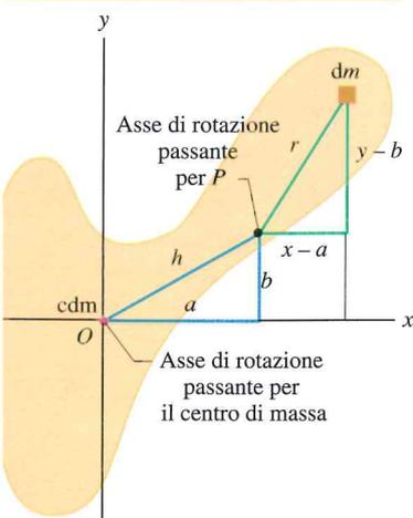
**Figura 10.11** Una sezione trasversale di un corpo rigido con il centro di massa in  $O$ . Il teorema degli assi paralleli dell'equazione 10.29 stabilisce la relazione fra i momenti d'inerzia rispetto a due assi paralleli, dei quali uno passa per il centro di massa  $O$ , l'altro per un punto  $P$  alla distanza  $h$  da  $O$ . Entrambi gli assi sono perpendicolari al piano della figura.
