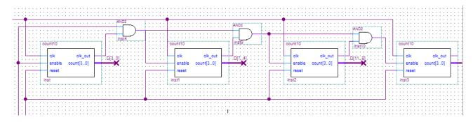
Questa architettura non crea più problemi dal punto di vista del disallineamento del clock in quanto tutti i blocchi risultano sincronizzati sullo stesso segnale ed inoltre non vi è alcun elemento di ritardo nella propagazione del clock.
