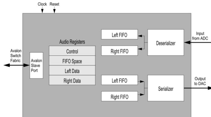
Inoltre vi sono 4 registri da 32 bits ciascuno per il controllo del sistema e dei dati: nel primo vi sono diversi bit di controllo, il secondo mantiene informazione sullo stato di riempimento delle FIFO in ingresso ed in uscita, mentre gli ultimi due registri quando usati in lettura forniscono i dati (rispettivamente del canale sinistro e destro) letti dal convertitore ADC, mentre se usati in scrittura forniscono i dati per il DAC.
