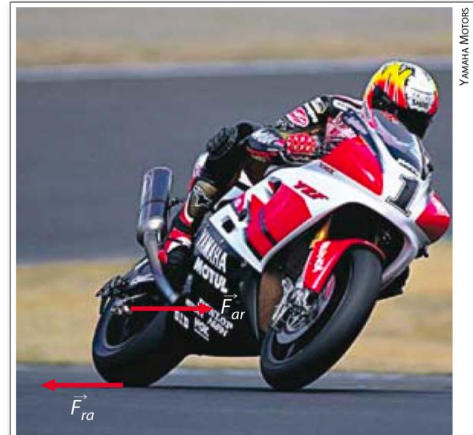
La motocicletta si muove perché l'asfalto reagisce alla forza della ruota con una forza uguale e opposta, applicata alla ruota:  $\vec{F}_{ra} = -\vec{F}_{ar}$
