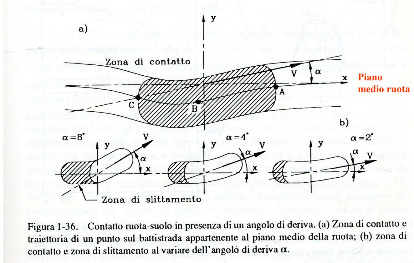
Figura 1-36. Contatto ruota-suolo in presenza di un angolo di deriva. (a) Zona di contatto e traiettoria di un punto sul battistrada appartenente al piano medio della ruota; (b) zona di contatto e zona di slittamento al variare dell'angolo di deriva  $\alpha$ .
