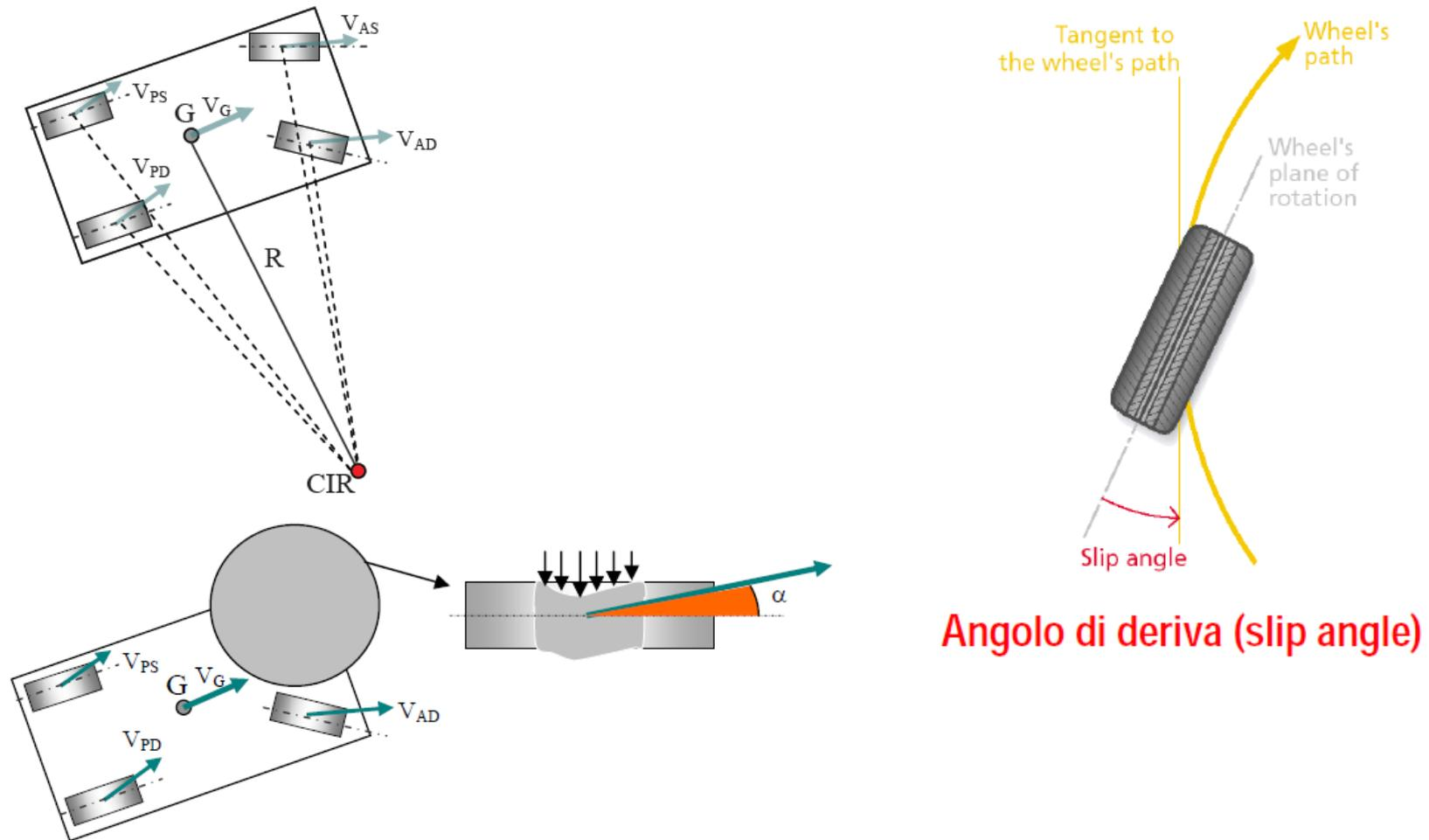
Figura 3-8: deformazione dell'impronta di contatto di uno pneumatico in deriva.
