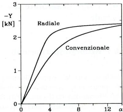
Figura 1-38. Andamenti schematici della forza  $Y$  con l'angolo di deriva  $\alpha$  per un pneumatico radiale e per uno convenzionale.
