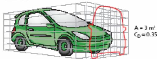
$k$  ( $0,010 - 0,040 \text{ kg/m}^3$ ) dipende dalla densità dell'aria ( $\rho$ ) e dalla forma del veicolo ( $C_x$ ),  $S$  ( $1,5 - 9,0 \text{ m}^2$ ) è la sezione maestra,  $V$  [km/h] velocità relativa tra veicolo e aria.
