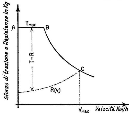
FIG. II.17 - Caratteristica di trazione (trattore a potenza costante).
