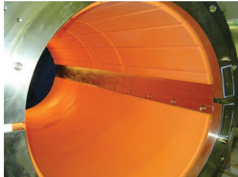
Boccola Thordon in materiale sintetico Composito con camicia in bronzo
