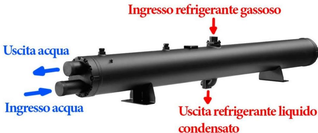
I materiali in caso di acqua salata sono più nobili di quelli usati per l'acqua dolce. I tubi di scambio usati per l'acqua salata sono in Cu/Ni nelle percentuali variabili (vanno scelte) di 90%/10% e 70%/30%.
