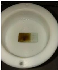
Film nanostrutturato di  $\text{MnO}_2$
