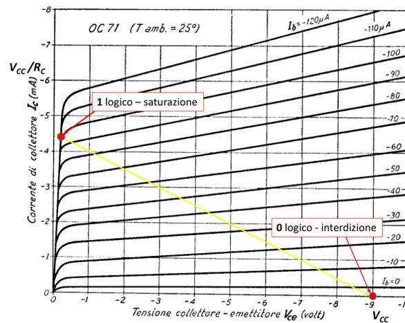
Figura 3.25: Transistor usato secondo la logica binaria
