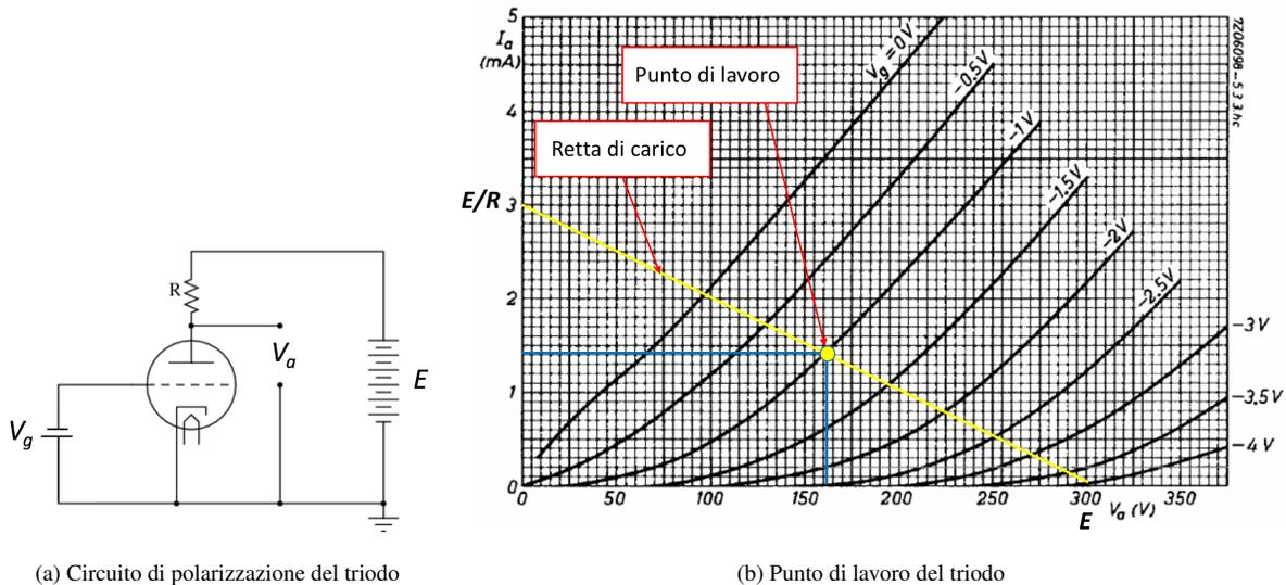
(a) Circuito di polarizzazione del triodo
