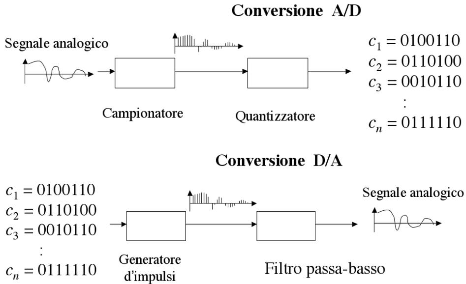
Figura 2.35: Conversione e riconversione di un segnale analogico
