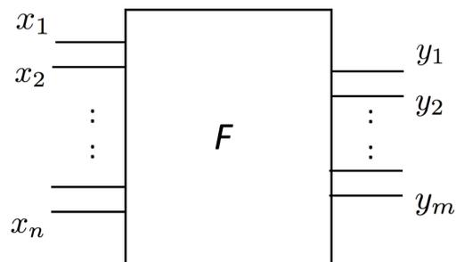
Figura 5.1: Struttura generale di un circuito combinatorio
