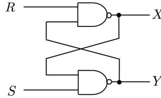
Figura 6.10: Flip-flop realizzato con due porte NAND
