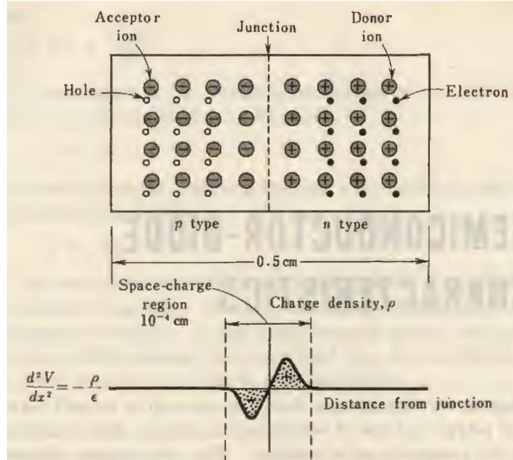
Figura 3.16: Barriera di potenziale di una giunzione p-n
