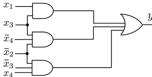
Figura 5.10: Circuito più economico che realizza la stessa funzione Booleana del circuito di figura 5.9a conviene realizzare è allora quello relativo all'espressione (5.2), ed è riportato in figura 5.10. ○
