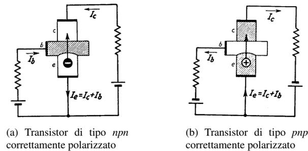
Figura 3.21: Polarizzazione dei transistor dei due tipi
