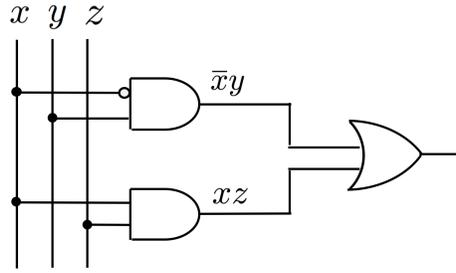
Figura 4.25: Circuito semplificato equivalente ai circuiti di figura 4.24
