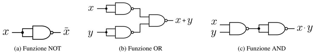
Figura 4.13: Funzioni NOT, OR e AND realizzate mediante una porta universale NAND
