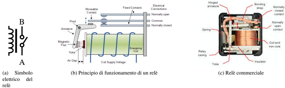
Figura 3.2: Struttura e funzionamento di un relè
