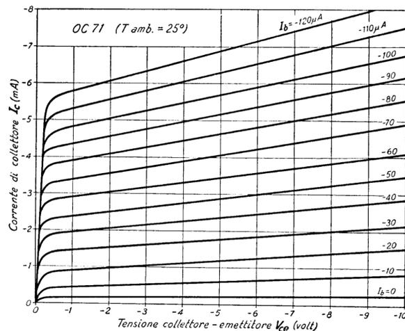
Figura 3.23: Curve caratteristiche di un transistor *pnp*
