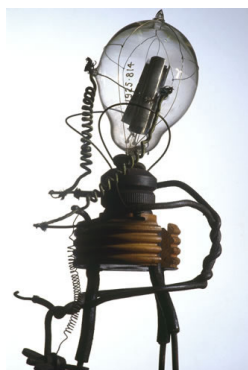
(a) Diodo a vuoto di Fleming (1904)
