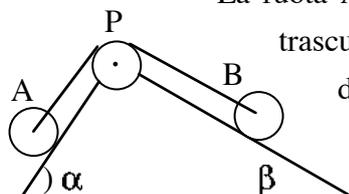
La ruota A è legata alla ruota B mediante una fune inestensibile, di massa trascurabile, che passa senza strisciare nella gola di una puleggia P. Le due ruote e la puleggia hanno tutte la stessa massa  $m$  e lo stesso raggio  $r$ , e possono essere assimilate a dischi omogenei; supponendo che le due ruote rotolino senza strisciare sul
