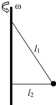
Un corpo puntiforme di massa  $m = 1$  Kg è collegato mediante due fili ideali, di lunghezze rispettivamente  $l_1 = 1$  m ed  $l_2 = 0.5$  m ad un'asta rigida verticale che ruota con velocità angolare  $\omega$ . I fili sono fissati all'asta in modo che, durante la rotazione, il filo più corto risulti ortogonale ad essa. Assegnata la tensione massima che possono sopportare i fili,  $T_{\max} = 60$  N, determinare il valore massimo di  $\omega$ .
