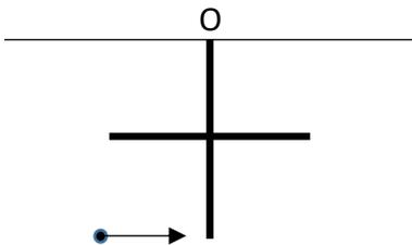
Due aste sottili identiche tra loro, ciascuna di massa 1.5 Kg e lunghezza 1.5 m, sono saldate fra loro nel punto centrale, a formare una croce. La croce è ferma, sospesa mediante un'estremità O a un vincolo ideale, che permette alla croce di ruotare senza attrito. Un proiettile di massa 0.2 Kg che viaggia con velocità orizzontale pari a 15 m/s colpisce l'estremo inferiore della croce, restandovi conficcato.
