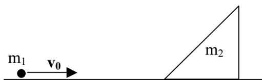
Un corpo di massa  $m_1 = 0.02$  kg si muove con velocità costante  $v_0 = 1.4$  m/s su un piano orizzontale privo di attrito. Il corpo nel suo moto incontra una rampa liscia inclinata di  $\alpha = 45^\circ$  rispetto all'orizzontale. La rampa, inizialmente in quiete, ha massa  $m_2 = 0.26$  kg e può muoversi senza attrito sul piano orizzontale. Si assuma liscio e smussato il raccordo tra piano orizzontale e rampa. Si determini:
