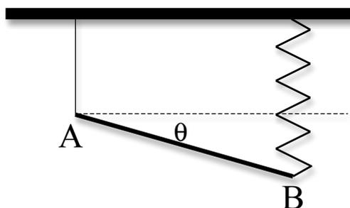
e di una molla (di costante elastica  $k$  e lunghezza a riposo nulla). La fune e la molla agiscono ai due estremi della sbarra, sono tese verticalmente e hanno l'altro estremo fissato al soffitto. Il punto A ha una distanza  $D = 0.2 \text{ m}$  dal soffitto e l'asta forma un angolo pari a  $\theta = \pi/6$  con la direzione orizzontale. Si determini il valore della costante elastica  $k$ .
