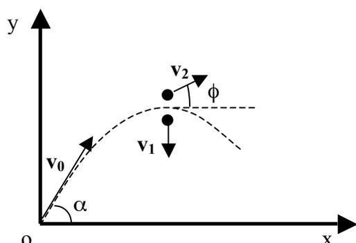
Un proiettile di massa  $M = 0.3$  kg viene lanciato con velocità  $v_0$  di modulo pari a 60 m/s e formante un angolo  $\alpha = 60^\circ$  con l'orizzontale. Al vertice della parabola il proiettile si spacca istantaneamente in due frammenti. Uno dei due frammenti ha massa  $m_1 = 0.1$  kg e la sua velocità, l'istante successivo allo scoppio, ha modulo  $v_1 = 90$  m/s ed è diretta verticalmente verso il basso. Calcolare:
