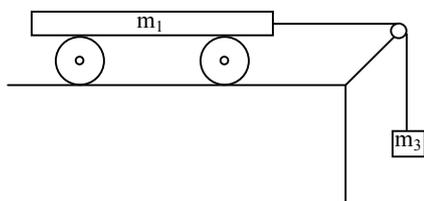
Il carrello in figura, di massa  $m_1 = 3 \text{ Kg}$ , è montato su quattro ruote omogenee di massa  $m_2 = 0.5 \text{ Kg}$ , che possono rotolare senza strisciare su un piano orizzontale. Al carrello viene attaccata una fune di massa trascurabile, che passa nella gola di una carrucola liscia, al cui secondo estremo è attaccato un corpo di massa  $m_3 = 1 \text{ Kg}$ . Calcolare il modulo dell'accelerazione del sistema, se  $m_3$  viene lasciato libero di cadere.
