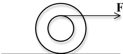
Sia  $m = M/2$ . Il rocchetto viene fatto rotolare con un moto di rotolamento puro su una superficie orizzontale, applicando una forza costante orizzontale  $F$  al bordo del cilindro interno. Determinare il valore di  $r$  per cui la forza di attrito tra dischi e piano risulta nulla.
