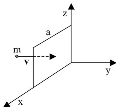
Una lamina omogenea quadrata di lato  $a$  e massa  $M$  è incernierata verticalmente lungo un suo lato. Una pallina di massa  $m$  urta elasticamente la lamina nel suo centro. La velocità della pallina prima dell'urto ha modulo  $v$  ed è diretta perpendicolarmente al piano della lamina. Determinare la velocità angolare  $\omega$  con cui si mette in rotazione la lamina ed il modulo  $v'$  della velocità di rinculo.
