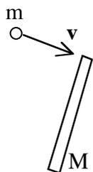
Una particella di massa  $m$  e velocità  $v$  urta elasticamente con l'estremità di una sbarra sottile uniforme di massa  $M$ , come indicato in figura. Dopo l'urto,  $m$  è ferma. Calcolare  $M$ . [NB:  $v$  è perpendicolare alla sbarra. Non c'è forza peso].
