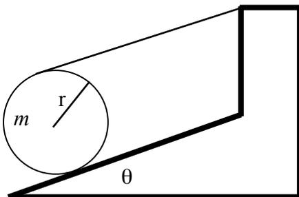
Un disco di massa  $m = 1$  Kg e raggio  $r = 20$  cm è tenuto fermo lungo un piano, inclinato di un angolo  $\theta = 30^\circ$ , mediante una corda tangente al disco e parallela al piano inclinato stesso. Si calcoli:
