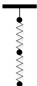
Tre sferette uguali, aventi ciascuna massa  $m$ , vengono sospese verticalmente al soffitto mediante un sistema composto da un filo inestensibile e senza massa e da due molle identiche, di massa trascurabile e costante elastica  $k$ , secondo la disposizione indicata in figura. Si determini, in condizioni di equilibrio:
