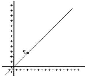
1. Due fili isolanti molto lunghi, carichi positivamente con densità di carica uniforme  $\lambda = 4 \text{ nC/m}$ , si incrociano ad angolo retto. Una particella di carica positiva  $q = 1.2 \text{ }\mu\text{C}$  e massa  $m = 2 \text{ g}$  si trova inizialmente ferma sul piano sul quale stanno i due fili, nella posizione  $P=(r_0, r_0)$  dove  $r_0=0.15 \text{ m}$  (in un sistema di coordinate che ha i due fili come assi). Calcolate:
