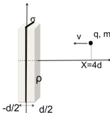
1. Una densità di carica volumetrica uniforme  $\rho = 10 \mu\text{C}/\text{m}^3$  è racchiusa in uno strato piano infinito di spessore  $d = 10 \text{ cm}$ . Al centro dello strato carico c'è un piano anch'esso infinito con densità di carica superficiale  $\sigma$ . Calcolate:
