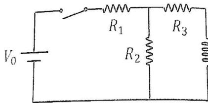
3. Nel circuito riportato in figura si ha che  $V=50.0 \text{ V}$ ,  $R_1=5.0 \Omega$ ,  $R_2=20.0 \Omega$ ,  $R_3=30.0 \Omega$ ,  $L=2.00 \text{ H}$ .
