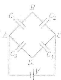
1. Nel circuito in figura il sistema di quattro condensatori, con  $C_1=4.0 \mu\text{F}$ ,  $C_2=6.0 \mu\text{F}$ ,  $C_3=9.0 \mu\text{F}$ ,  $C_4=12 \mu\text{F}$ , e' sottoposto alla differenza di potenziale  $V=100 \text{ V}$ .
