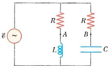
3. Nel circuito in figura il generatore fornisce una f.e.m. con  $V_{\max} = 311 \text{ V}$  e  $\nu = 50 \text{ Hz}$ , le resistenze sono identiche e valgono  $R = 100 \Omega$ ; inoltre  $L = 50 \text{ H}$  e  $C = 0.1 \text{ mF}$ .
