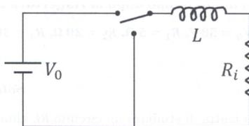
3. In un circuito di resistenza  $R_i$ , un induttore, collegato ai morsetti di una batteria con f.e.m.  $V_0=3$  V, e' attraversato da una corrente  $I_0=24$  A. A  $t=0$  gli estremi dell'induttore vengono istantaneamente cortocircuitati, a  $t=0.2$  s si misura una corrente pari a  $I_0/2$ .
