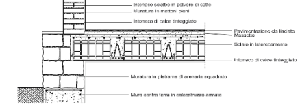
1 - Particolare solaio interpiano - scala 1:20
