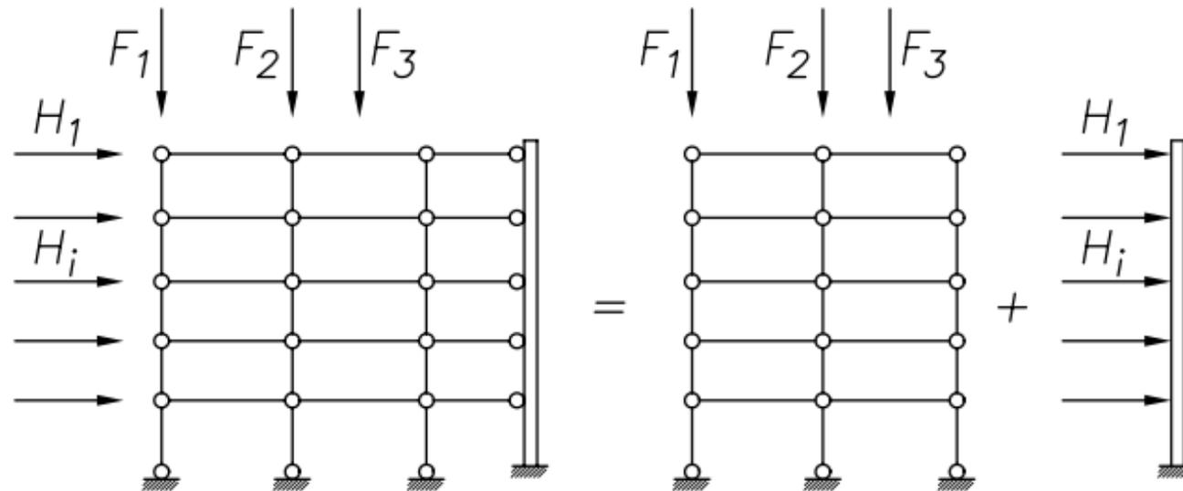
Nel caso in cui il telaio sia efficacemente controventato, la progettazione risulta semplificata in quanto, con riferimento alla generica situazione di carico, è possibile operare il dimensionamento del sistema privo di controvento per i soli carichi verticali, e del controvento per tutte le azioni verticali e orizzontali che gravano su esso.
