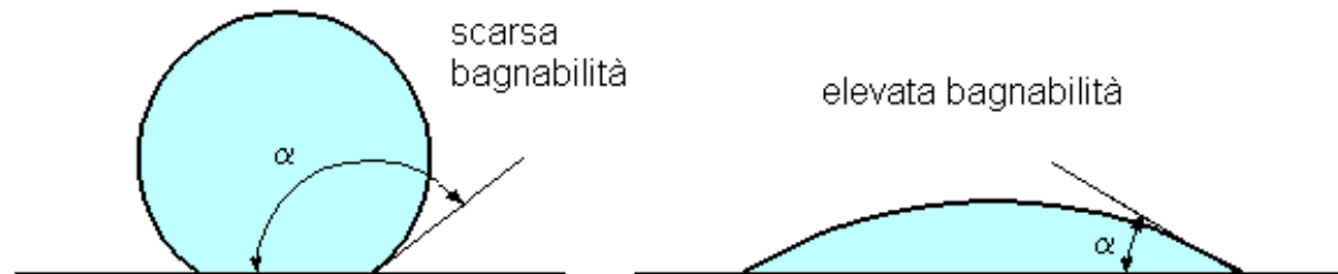
Figura 10 - L'angolo di contatto di un liquido con un solido viene utilizzato come indice di bagnabilità. Per \alpha < 90^\circ il liquido bagna la parete (es: acqua su vetro), per \alpha > 90^\circ il liquido non bagna la parete (es: mercurio su vetro). Se \alpha = 0^\circ si dice che il liquido bagna perfettamente la parete.
